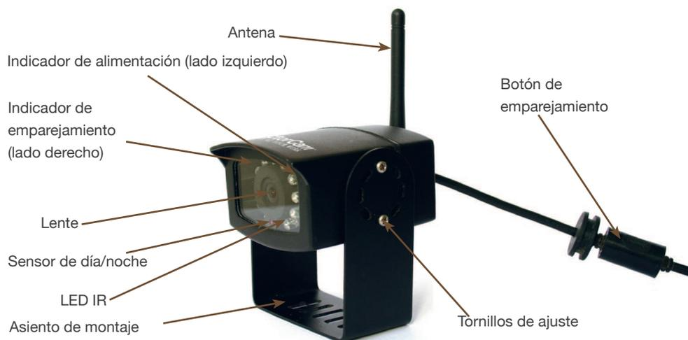
*Para cambiar el ángulo de la cámara, mueva los tornillos de ajuste hasta obtener al ángulo deseado. Apriete los tornillos de ajuste poco a poco, para evitar dañar las roscas.*
