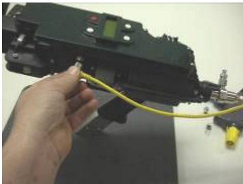
Localice la entrada de conexión en el costado del inyector y conecte el cable amarillo.
